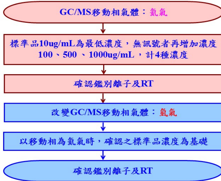
圖三 建立西藥標準品鑑別離子及滯留時間之方法流程圖
